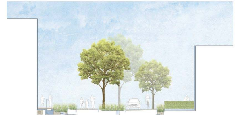
Gärten mit Holzterrasse Gießwasserzisterne und Tiefbeet Tiefbeet Gehweg mit Sickerbeilagen Mulde als Retentionsfläche mit wechselsfeuchten Zonen Tiefbeet
