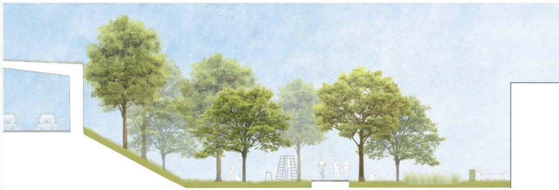
Böschung mit Gehölz Grüner Ring mit Spiel- und Sportflächen Rundweg als Erlebnisraum, für Jogger und Spaziergänger Mulde zur oberflächennahen Versickerung
